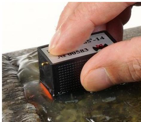
Гель "Миасс" используется для создания качественного контакта ультразвукового преобразователя с изделием. Гель представляет собой коллоидный раствор силиконовых полимеров в воде. Для его производства используются материалы, применяемые в аэро-космической отрасли.
