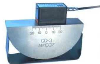
Определение точки ввода преобразователя на мере СО-3
