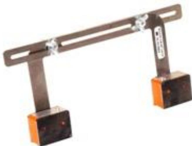
Ультразвуковой контроль стыковых сварных соединений элементов строительной арматуры выполняют зеркально-теневым методом с использованием специализированного преобразователя ПА 123-1,8-65°-14\* 14 (Рис. 1.) с дефектоскопа общего назначения УД9812. Методика контроля регламентируется ГОСТ 23858-79.
