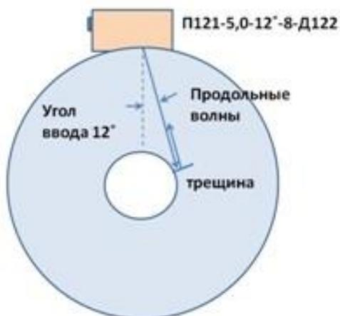
Преобразователи используются для выявления трещин на внутренней поверхности труб с большой толщиной стенки. Данные ПЭП излучают продольный волны и имеют малые углы ввода.
