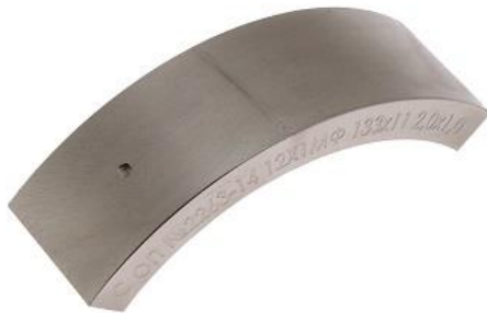
СОП трубный, диаметр 133, толщина 11 мм
