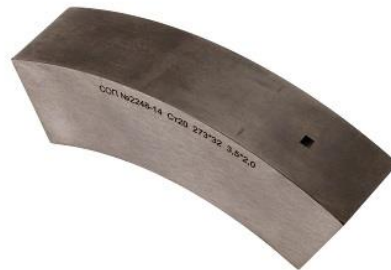
СОП трубный, диаметр 273, толщина 32 мм
