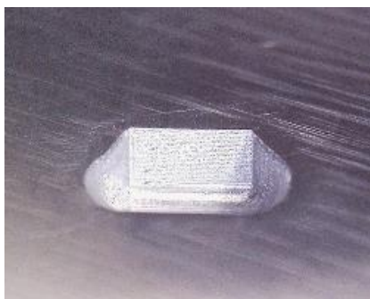
Зарубка 2,0x1,0 мм Вид на вертикальную стенку
