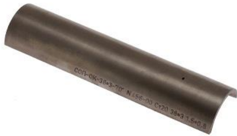
СОП трубный, диаметр 38 мм, толщина 3 мм
