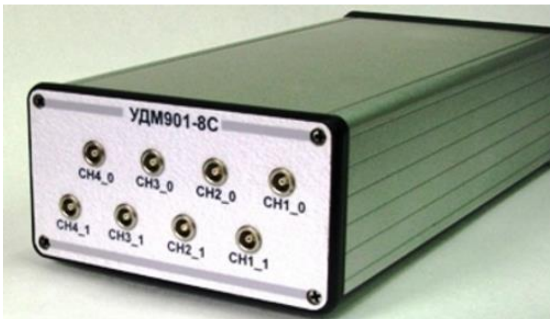
Рис.1.1. Ультразвуковой модуль УДМ901
