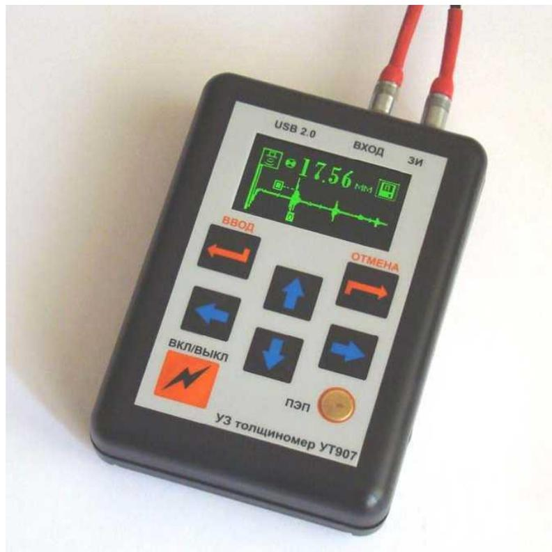
Рис.1.1. Ультразвуковой толщиномер УТ907
